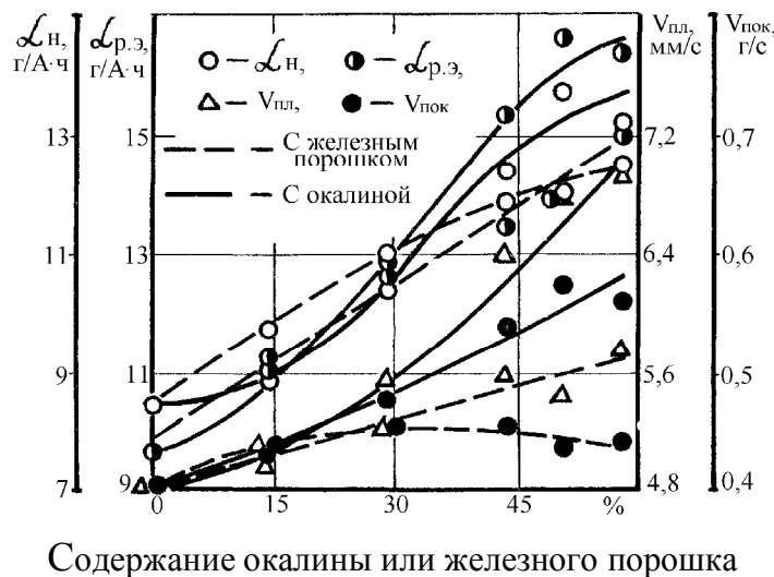
Рис. 1. Показатели плавления электродов в зависимости от содержания в покрытии окалины или железного порошка
