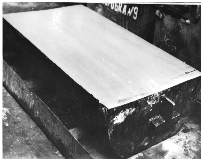
Рис. 4. Вид поперечного сечения пятитонного слитка, отлитого на печи ЭШП-10Г
